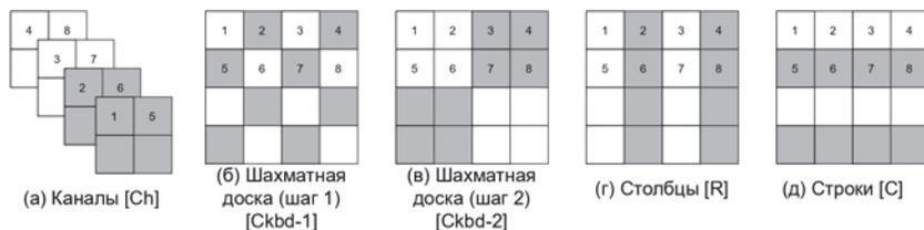
Рис. 6. Схемы бинарных масок для соединительных слоев
